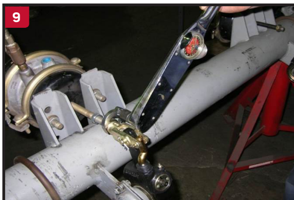
Usando un torquímtero, apriete la tuerca de 1/4" a la horquilla, con un torque de 40 a 50 lbs./pie, posteriormente, apriete la tuerca de 15/16", vs el seguro de tuerca, con el mismo torque, 40 a 50 lbs./pie.
