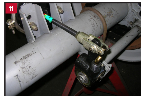
Aplique los frenos a fondo y suelte el pedal, permitiendo a la varilla de la cámara de freno, que viaje hasta su máxima carrera.
