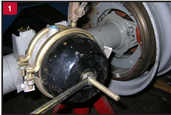
Si el eje cuenta con este tipo de frenos de aire, bloquee manualmente los frenos, siguiendo las recomendaciones del fabricante.
