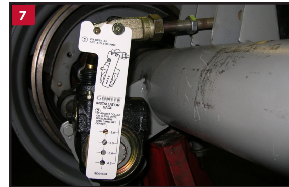
Después de apretar la tuerca de 1/4" a la horquilla, asegúrese que la rosca de la espiga este completamente enroscada en la tuerca hexagonal de 3/4".
