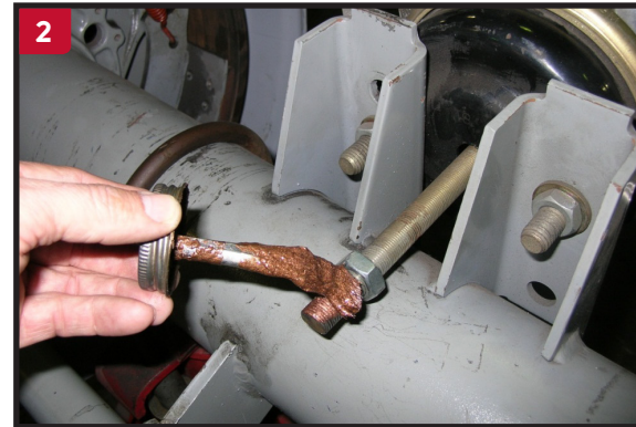
Aplique antiadherente a los roscas de las varillas de la cámara de frenos, antes de instalar horquillas nuevas.
