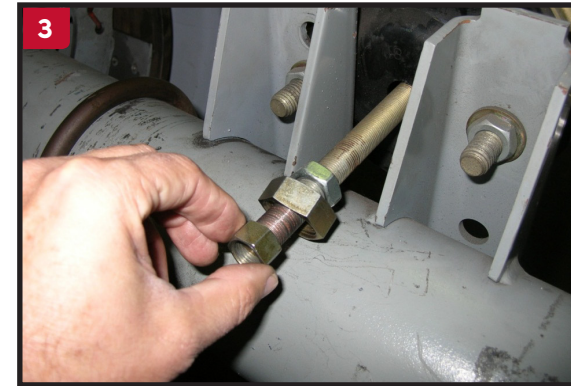
Coloque una tuerca de 1/4" en las espiga contra la tuerca de 15/16" de la varilla. Enrosque la tuerca de 3/4" en la varilla.
