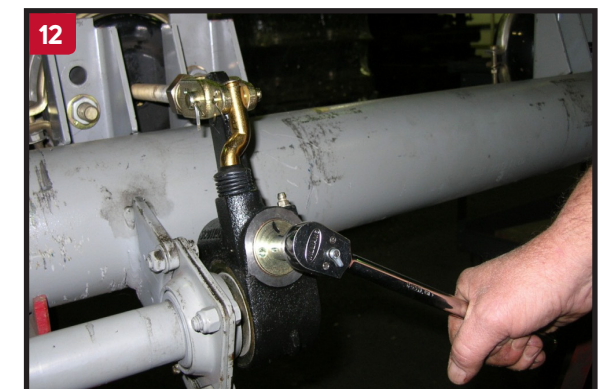
Ajuste los frenos girando el ajustador hexagonal, de acuerdo a las manecillas del reloj, hasta que las balatas, toquen el tambor. Regrese el Ajustador, girando la ajustador hexagonal, 1/2 vuelta, al contrario de las manecillas del reloj, lo anterior requiere, de 30 a 50 lbs./pie de torque. Escuchara un sonido como de "matraca", cuando regrese el ajustador. Al completar este paso, desbloquee los frenos ver el cuadro No. 1.
