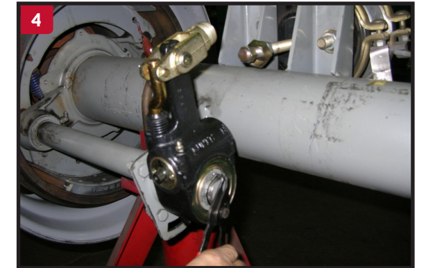
Instale el Ajustador usando al menos una roldana interior, para alinear el Ajustador con la espiga de la cámara de freno y coloque roldanas exteriores, solo las suficientes, para que el Ajustador no se mueva a mas de 0.060", una vez instalado. Asegure el ensamble con el Seguro.
