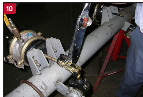
Una vez que la tuerca ha sido apretada a la horquilla, apriete la tuerca 15/16", contra el tuerca de seguro con un torque de 40 a 50 lbs./pie.
