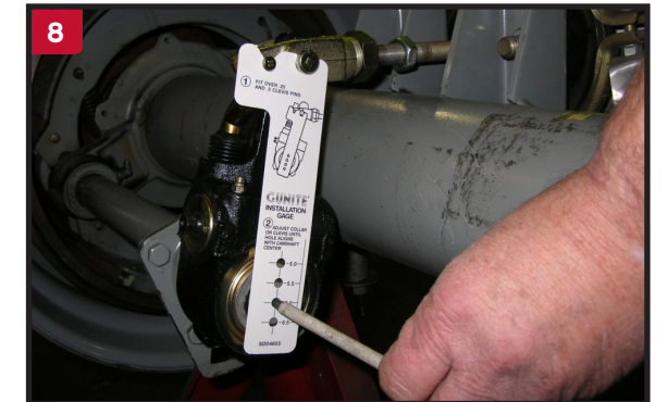
Alinee el ajustador, apretando la tuerca de 3/4" de la espiga, hasta que el correspondiente agujero de la plantilla, quede alineado con el agujero central del engrane del ajustador, como se muestra arriba.
