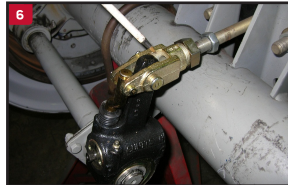
Antes de colocar la tuerca de 1/4" a la horquilla, asegúrese que la rosca de la espiga este completamente enroscada en la tuerca hexagonal de 3/4". La espiga puede extenderse hasta 1/16", después de la horquilla. Si se extiende mas de 1/16", después de la horquilla, deberá cortar el vástago.
