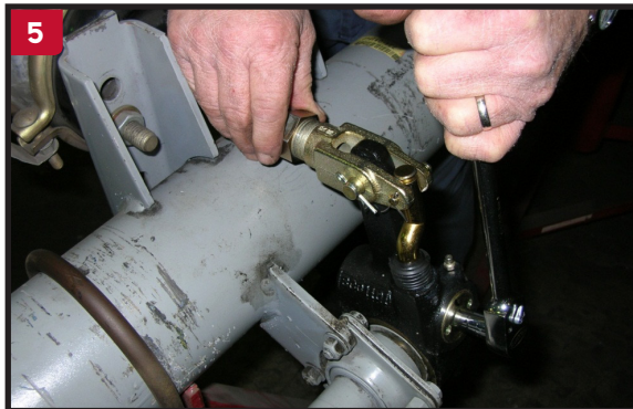
Usando una llave, apriete el ajustador con la tuerca y alinee la rosca con la horquilla.
